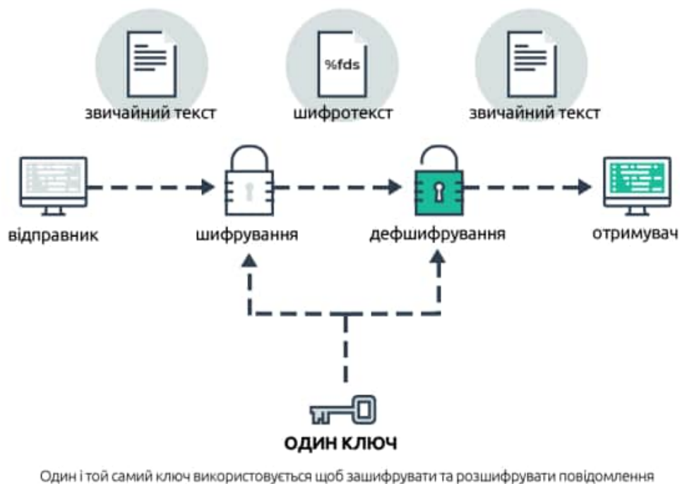
Рисунок 1.1 – Схема шифрування симетричним алгоритмом
