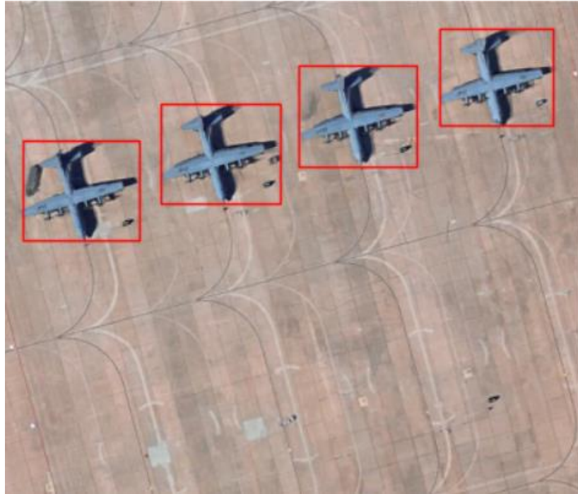
Рис. 3.8 – Виявлені моделлю YOLOv5 літаки
