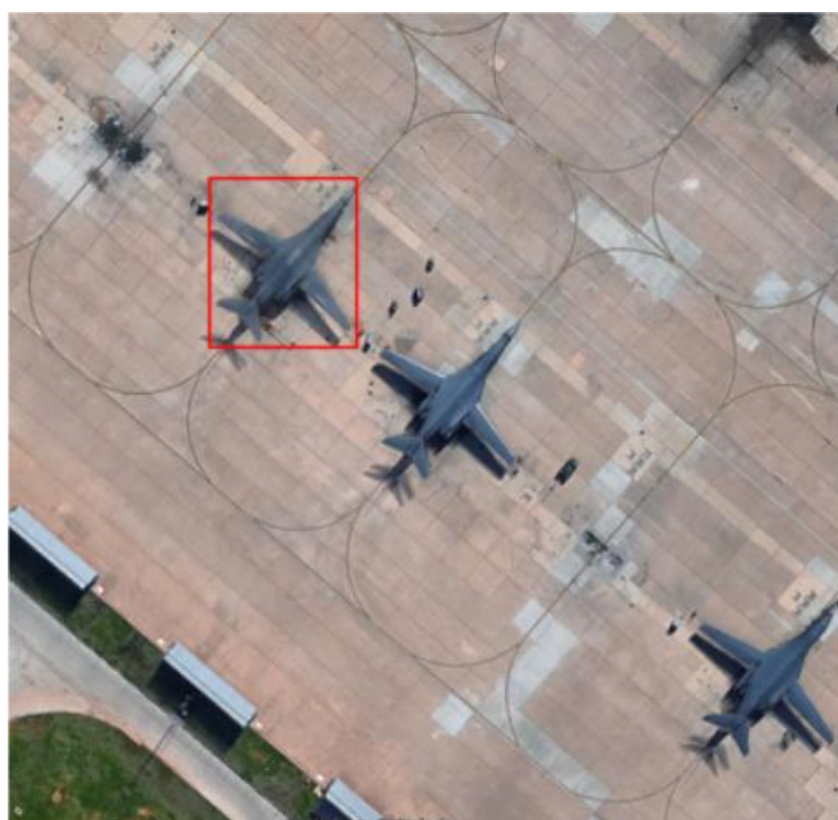
Рис. 3.7 – Виявлений літак за допомогою моделлю YOLOv5
