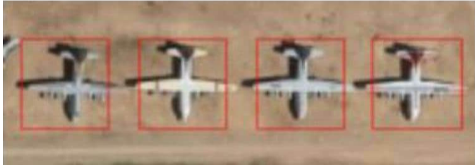
Рис. 3.6 – Виявлені моделлю YOLOv5 літаки
