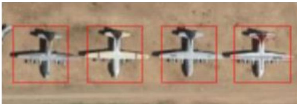
Рис. 3.6 – Виявлені моделлю YOLOv5 літаки
