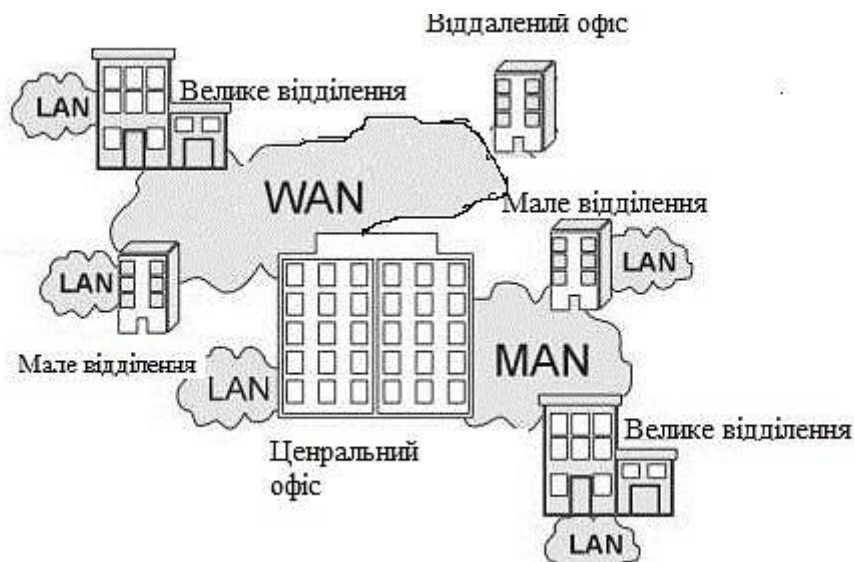
Рисунок 2.1 – Схема корпоративної мережі
