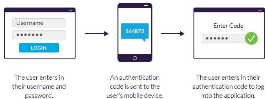
Рисунок 3.6 – Принцип дії двофакторної аутентифікації
