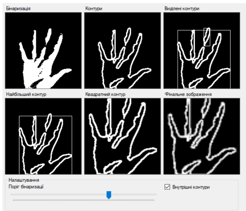
Рис. 3.15 Результат погано підбраного порогу бінаризації – поріг зависокий
