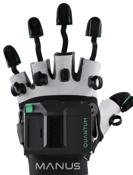
Рис. 1.3 Приклад рукавиці для технології захоплення руху
