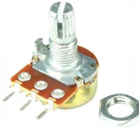
Рис. 1.8 – Потенціометр, використаний для регулювання висоти дрона
