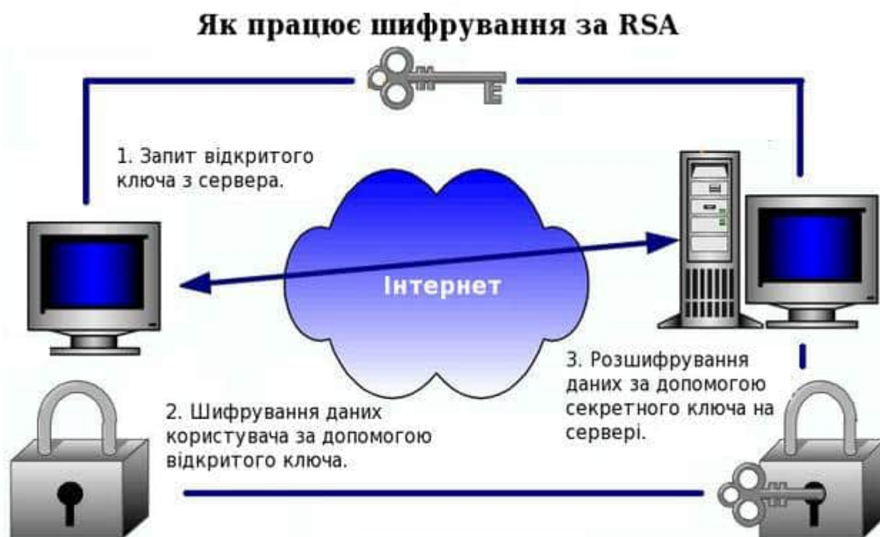
Рисунок 3.1— Опис принципу функціонування алгоритму RSA.
