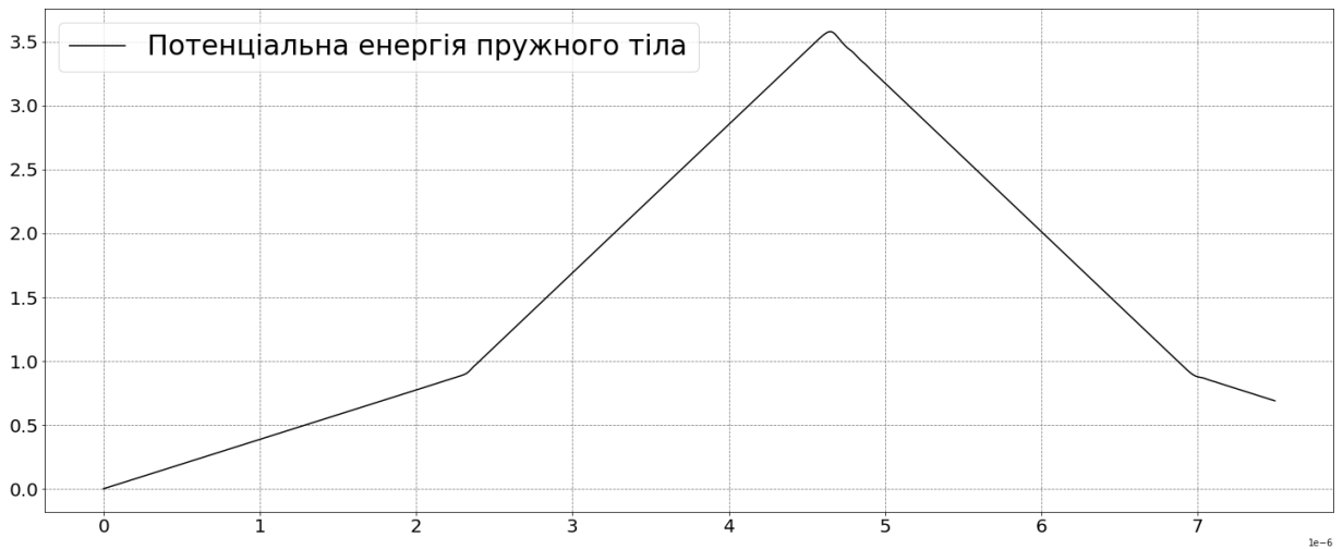
Рис. 7.3. Покрокова зміна потенціальної енергії пружного тіла в часі.
