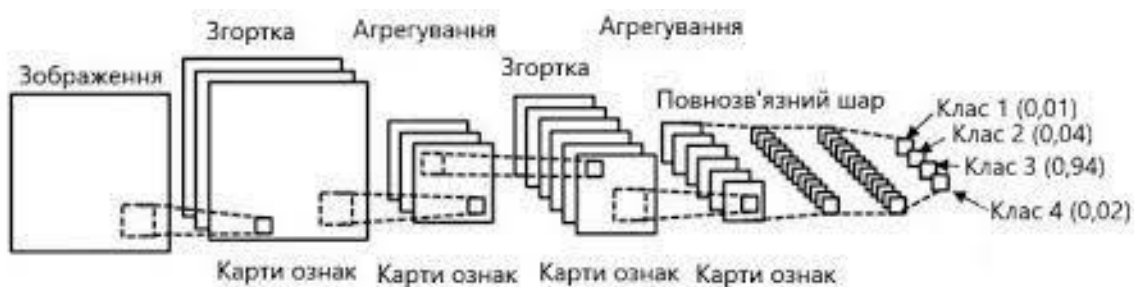
Рисунок 2.2. Приклад використання двохвимірної згортки для формування карти ознак
