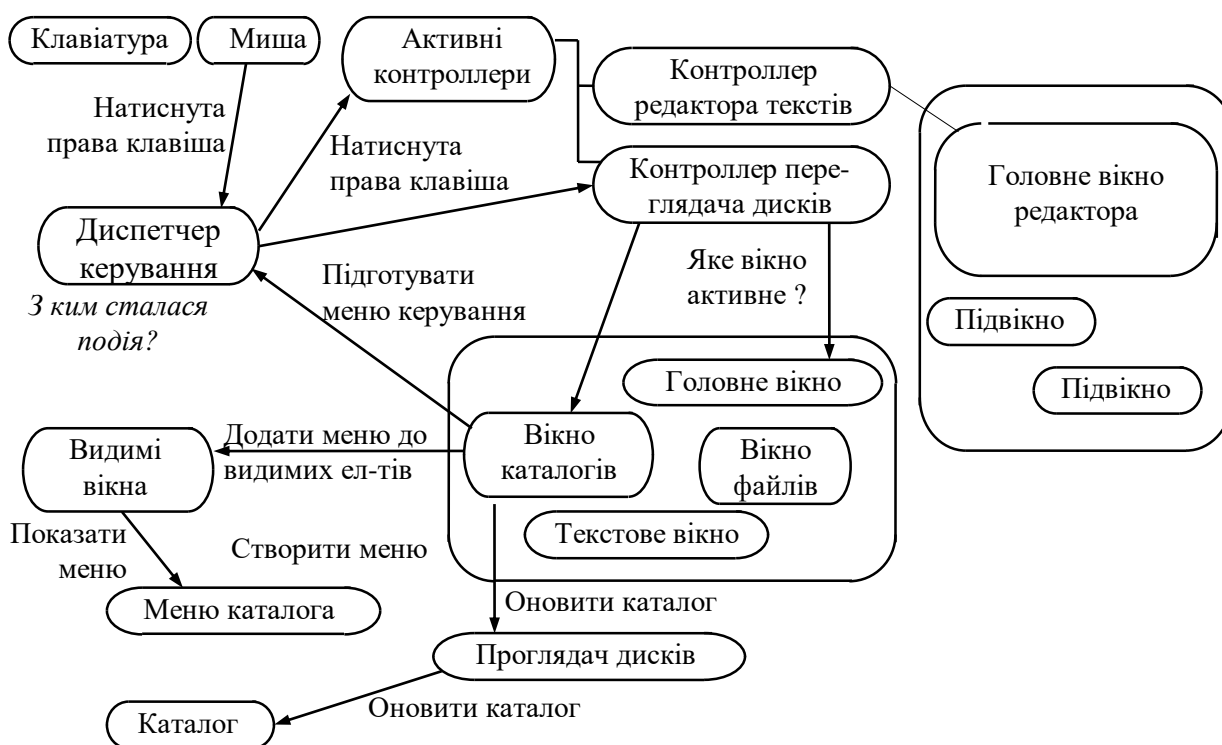
Рис. 1. Система складається з об'єктів, пов'язаних між собою передаванням повідомлень. Це зменшує кількість з'єднань між компонентами системи, а тому збільшує її модульність
